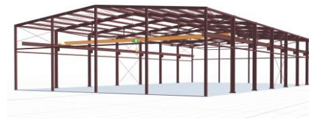
Каркас производственного цеха с кран-балкой, 1440 кв.м
